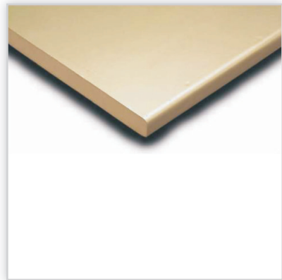
EUROTHANE AL QUATTRO. Bezfreonowa, samogasnąca, poliuretanowa, twarda płyta pokryta dwustronnie i na dłuższych krawędziach laminatem paroizolacyjnym (papier typu kraft+folia aluminiowa). Wykończenie krawędzi: prosta, frezowana oraz frezowana pod profil krzesielkowy. Zastosowanie: izolacja wewnętrzna budynków w sektorze rolniczym i przemysłowym. \lambda_d [W/(mK)]: 0,025-0,028. Wymiary [mm]: 1227/maks. 13000/(30-60) lub 1200/13000/(20-40) – płyta Eurothane AL.
