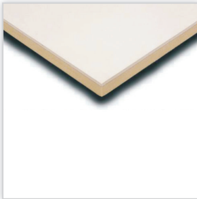
EUROTHANE G. Bezfreonowa, twarda poliuretanowa płyta termoizolacyjna wykończona jednostronnie płytą gipsowo-kartonową. Zastosowanie: ściany i poddasza od wewnątrz, zimne klatki schodowe. Zalety: doskonały efekt izolacyjny i podłoże gotowe do malowania, tapetowania, pokrycia płytkami ceramicznymi, łatwy montaż, oszczędność powierzchni użytkowej. \lambda_d [W/(mK)]: 0,022. Wymiary [mm]: 1200/2600. Grubość PIR [mm]: 20-60, 80, 100, 120.
