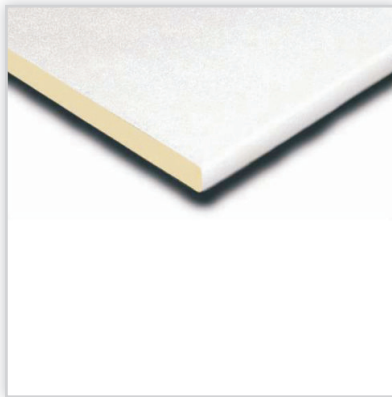
POWERLINE (QUATTRO). Bezfreonowa, twarda poliizocjanurowa płyta termoizolacyjna, pokryta obustronnie warstwą grubej, karbowanej folii aluminiowej o grubości 50 \mu . Wierzchnia strona pokryta dodatkowo białym lakierem. Dłuższe boki zabezpieczone okładziną aluminiową. Zastosowanie: wewnętrzna termoizolacja połaci dachowych montowana w systemie plastikowych profili H-Profilisol. \lambda_d [W/(mK)]: 0,024. Wymiary [mm]: 1227/maks. 8000/(30-100).
